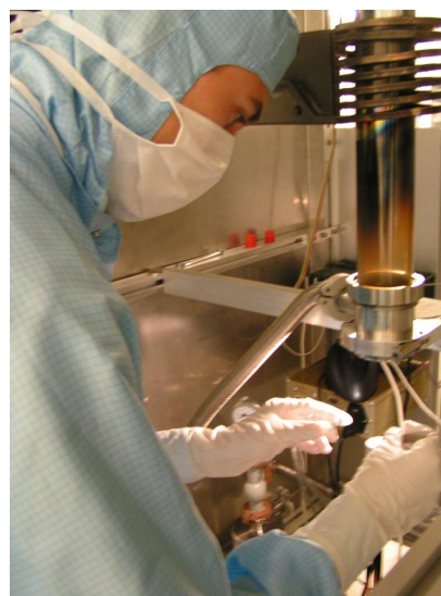
Wymywanie próbki z komory nowego reaktora MOVPE
