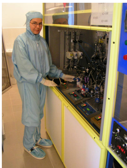
Pojemniki z metalorganikami starego reaktora MOVPE — przygotowanie reaktora do wzrostu
