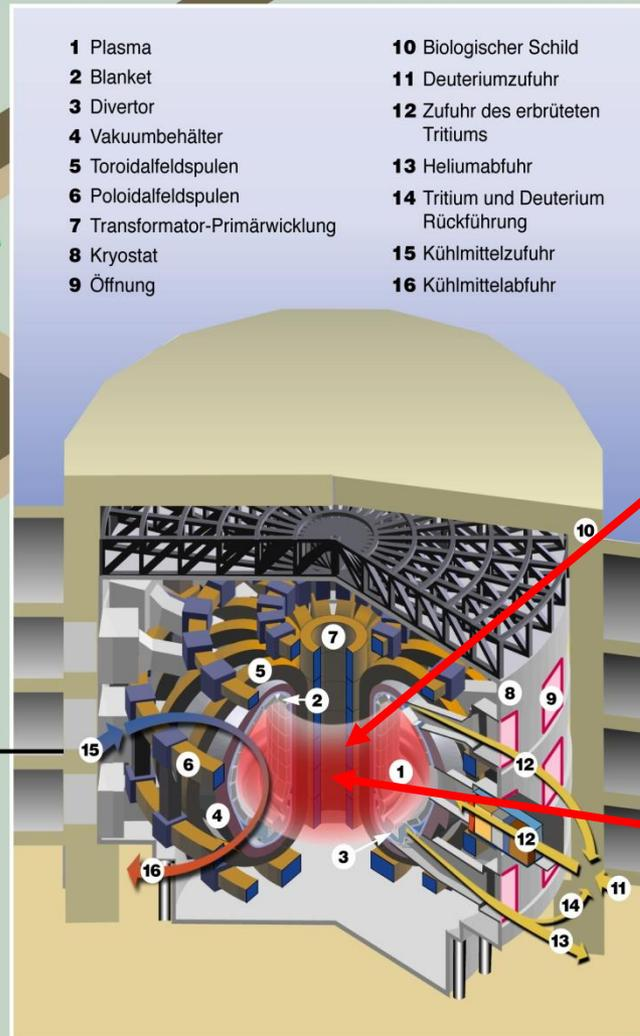
Das Fusionskraftwerk der Zukunft
