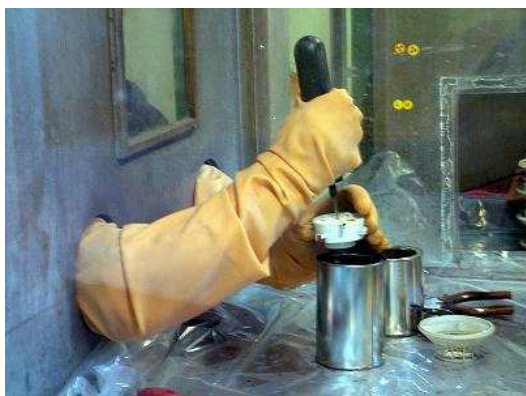
Rys. 5. Boks do demontażu czujek dymu.
