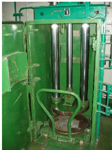
Rys. 1 i 2. Prasa hydrauliczna wykorzystywana do prasowania odpadów stałych.
