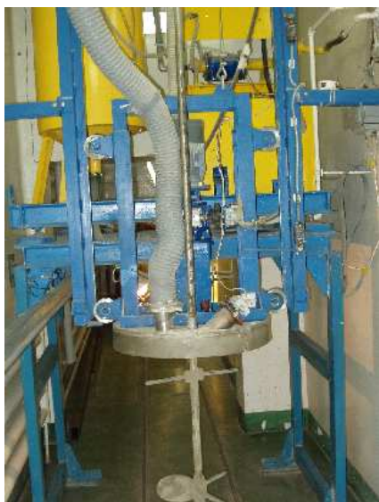
Rys. 7, 8. Instalacja do cementowania szlamów postrąceniowych i koncentratów powyparnych.
