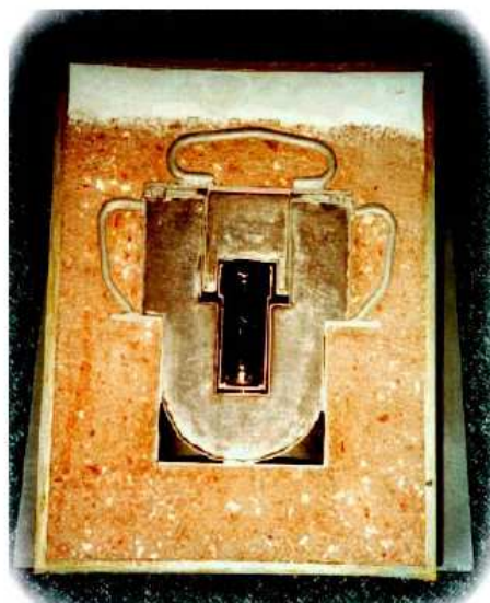
Rys. 3, 4. Przekrój przez pojemnik na wycofane z użytkowania zamknięte źródła radowe.
