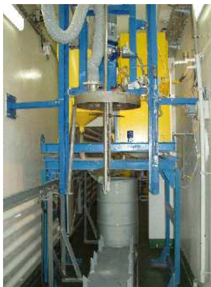
Rys. 7, 8. Instalacja do cementowania szlamów postrąceniowych i koncentratów powyparnych.
