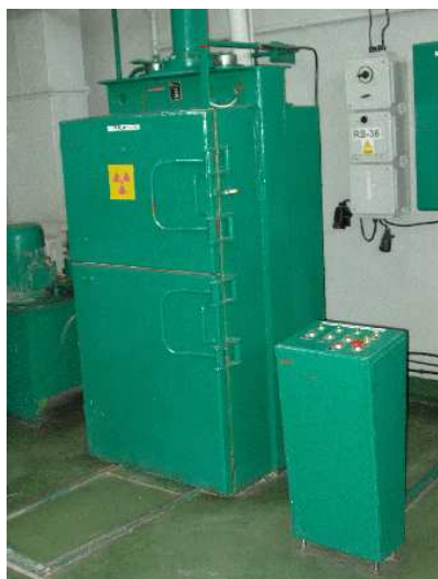
Rys. 1 i 2. Prasa hydrauliczna wykorzystywana do prasowania odpadów stałych.
