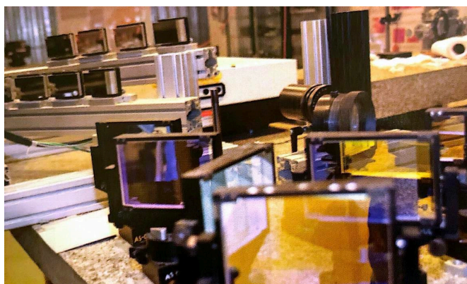
Rysunek 4.10: Układ 16-kadrowego interferometru, który jest stosowany do badań plazmy w urządzeniu PF1000U. Źródło: Archiwum IFPiLM
