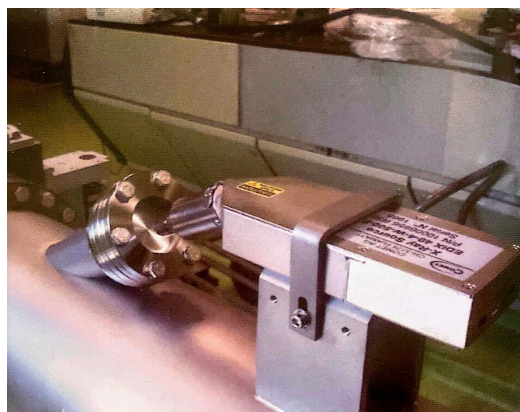
Rysunek 4.3: Układ pomiarowy do badania promieniowania rentgenowskiego obecnego w urządzeniu W7-X w Niemczech. Układ przygotowano w ramach projektu EUROfusion. Źródło: Archiwum IFPiLM.
