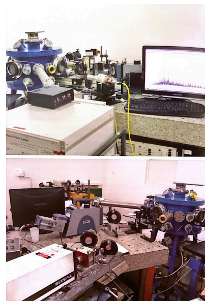
Rysunek 4.8: Układy służące do badania usuwania kodepozytu laserem za pomocą metody LIBS. Źródło: Archiwum IFPiLM
