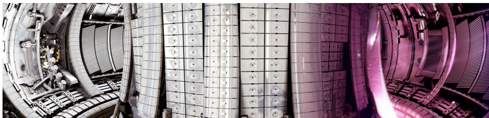
Rysunek 3.1: Wnętrze komory tokamaka JET. Widoczna różowa poświata to plazma obecna w działającym urządzeniu. Zaznaczyć należy, że plazma na ogół jest niewidzialna. W zakresie promieniowania widzialnego promieniuje tylko plazma relatywnie chłodna. Źródło: [20]
