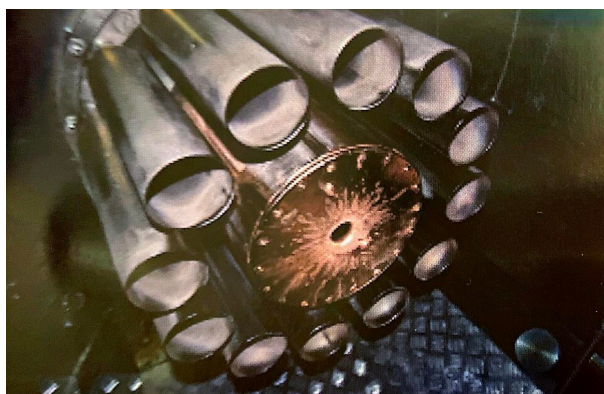
Rysunek 4.9: Elektrody wewnątrz układu PF1000U. Cylindryczna elektroda wewnętrzna jest otoczona zewnętrzną rurą elektrodą zewnętrzną. Źródło: Archiwum IFPiLM
