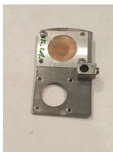
Rysunek 12: Tarcza po doświadczeniu, widać zmianę koloru tam gdzie padała wiązka
