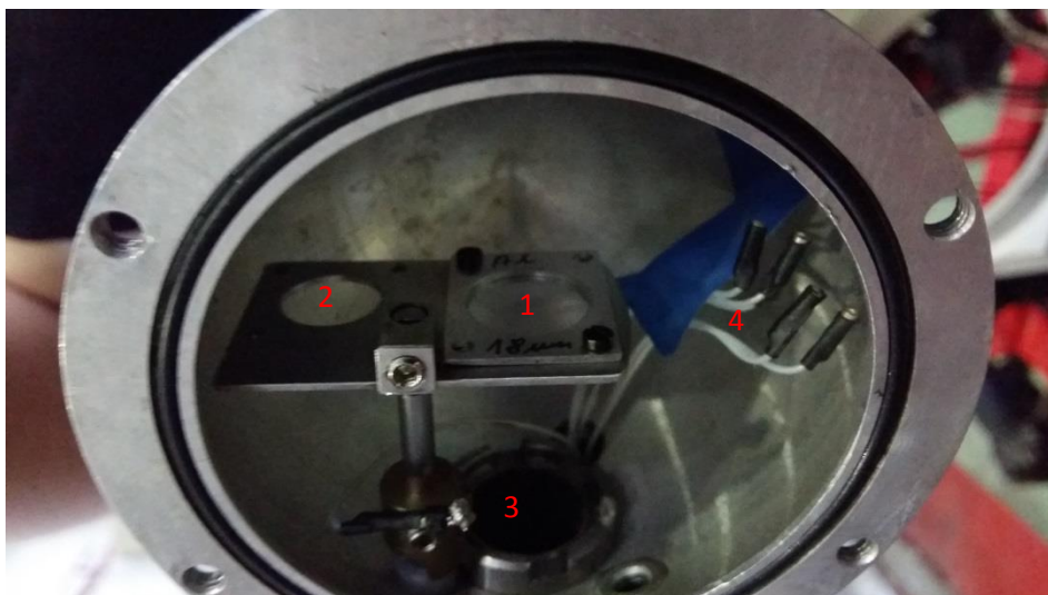
Zdjęcie 16. Wnętrze komory z zamocowanym targetem
