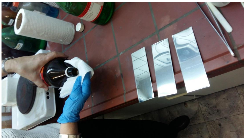
Zdjęcie 12. Oczyszczanie metalu na „kanapkę”
