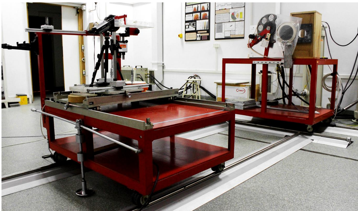
Rysunek 14. Stanowisko kalibracyjne promieniowania rentgenowskiego. Od lewej: tawa kalibracyjna, obudowa z lampą rentgenowską (do obudowy przymocowana jest karuzela z warstwami półchłonnymi).
