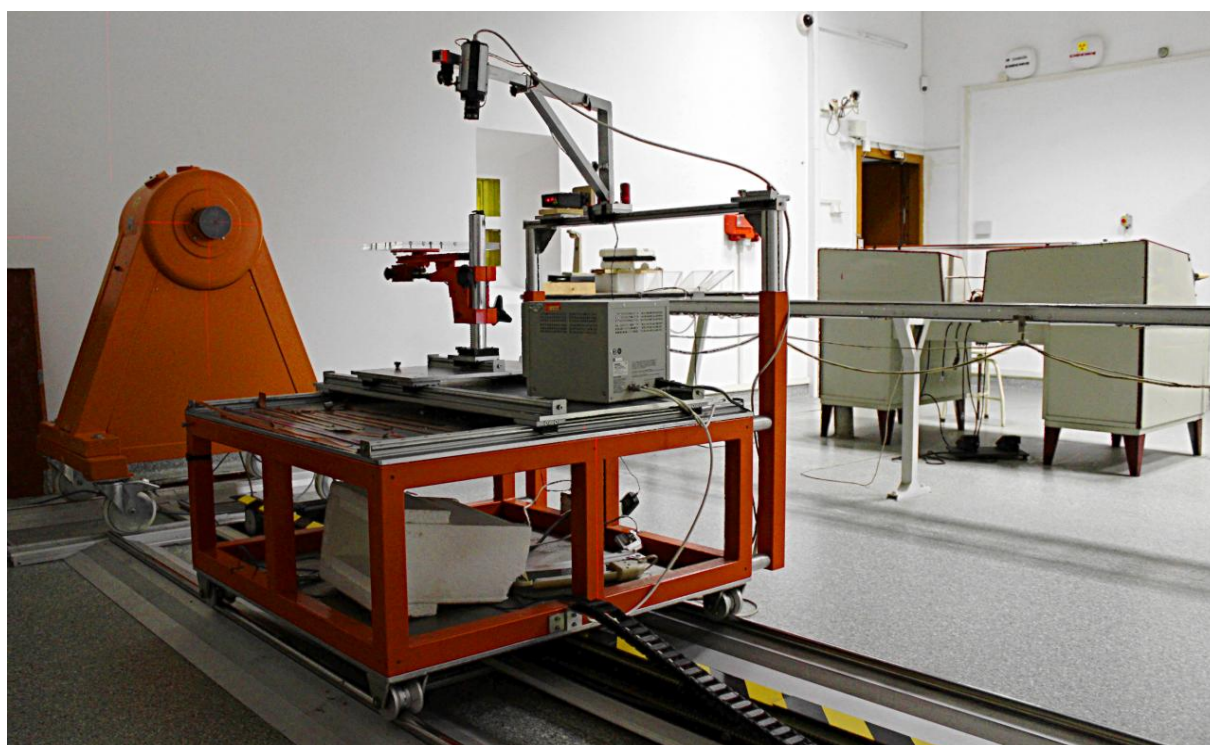
Rysunek 13. Stanowisko kalibracyjne gamma w CLOR. Od lewej: urządzenie napromieniowujące, ława kalibracyjna.
