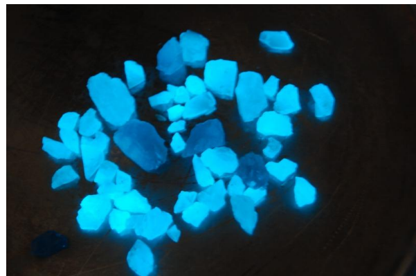
Rysunek 4. Termoluminescencja fluorytu podgrzewanego nad palnikiem kucharki przy zgaszonym świetle. Źródło: [8]
