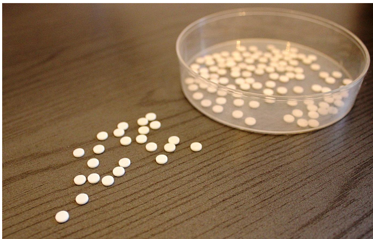
Rysunek 9. Pastylki termoluminescencyjne LiF:Mg,Cu,P (MCP-N) wykorzystywane przez Centralne Laboratorium Ochrony Radiologicznej.
