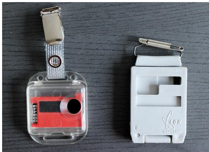
Rysunek 10. Nowe i stare: dawkomierz TLD (po lewej) i obudowa dawkomierza fotometrycznego (po prawej) stosowane przez CLOR.
