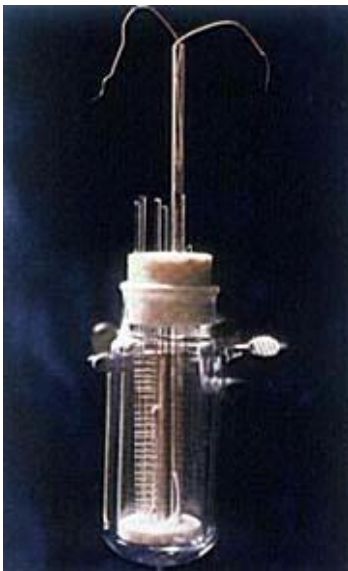
Rysunek 15 - Stoik z elektrodami, w którym rzekomo zachodzi zimna fuzja [7]
