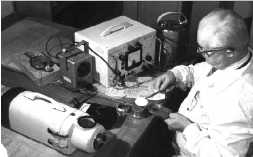
Fot 4. Przygotowanie do pomiaru próbki pyłów zebranych na filtrze.
