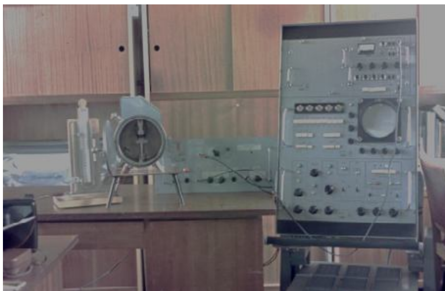
Fot. 8 Spektrometr promieni alfa z detektorem krzemowym wykonany przez inżynierów CLOR
