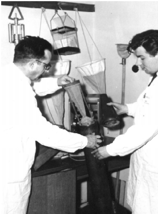
Fot. 12 Wodna sonda zwana przez marynarzy „gul-gul” służąca do zbierania próbek planktonu z wody
