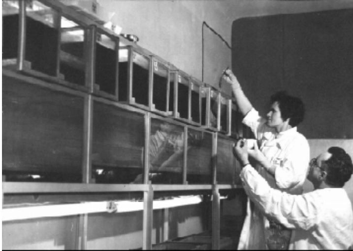
Fot 11 Akwaria do laboratoryjnych badań hydrobiologicznych nad cezem-137.
