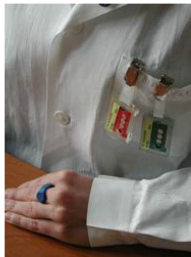
Fot. Po lewej. Dawkomierz typu ALBEDO Pomiar: Hp(10) Zakres: 0,1 mSv - 1 Sv
