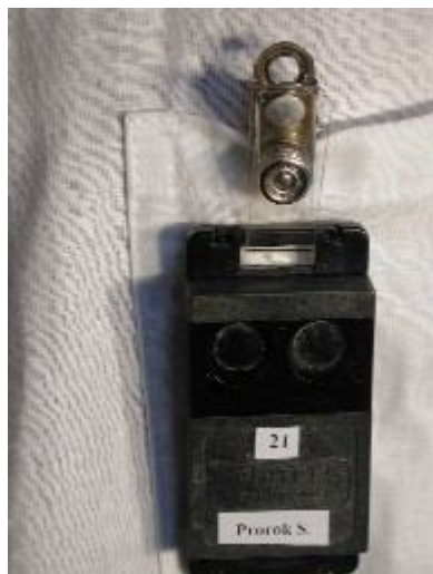
Fot. Po lewej. Dawkomierz typu ALBEDO Pomiar: Hp(10) Zakres: 0,1 mSv - 1 Sv
