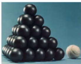
Rys18. Kulki grafitowe zawierające w sobie zasklepione paliwo [31].
