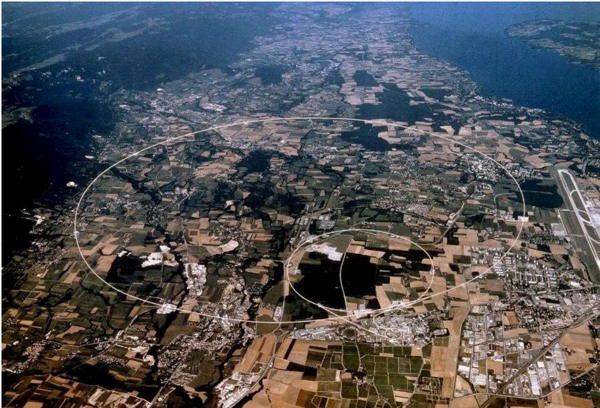
Rys.2.2.31b. Fotografia lotnicza pokazująca wielkość pierścieni akceleratorów CERNu. Pokazany na fotografii duży okrąg LHC znajduje się ok. 100m pod powierzchnią ziemi.
