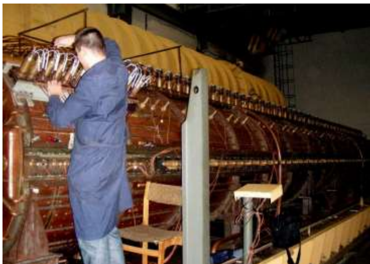
Rys.2.2.15a. Akcelerator liniowy w Laboratorium Fizyki Wysokich Energii Zjednoczonego Instytutu Badań Jądrowych w Dubnej k. Moskwy stanowi pierwszy element systemu akceleracyjnego ciężkich jonów „Nuclotron”
