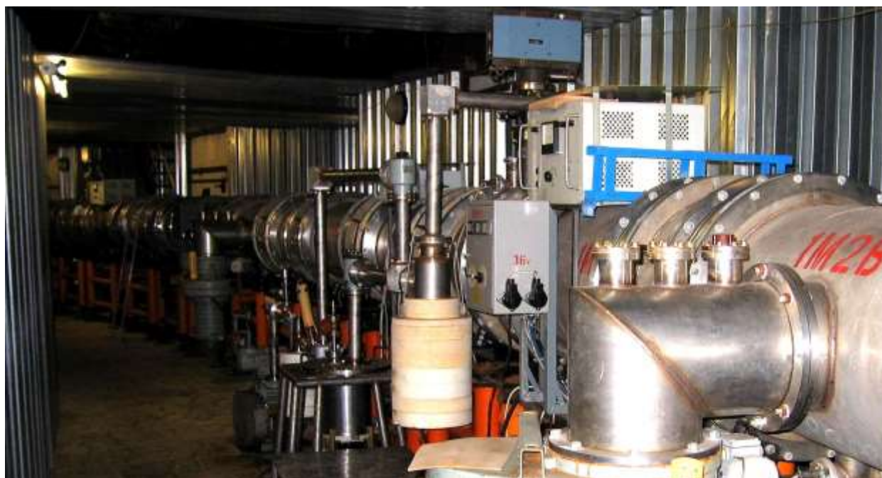
Rys. 2.2.1a. Akcelerator ciężkich jonów „Nuclotron” w Zjednoczonym Instytucie Badań jądrowych w Dubnej k. Moskwy (fragment pierścienia o średnicy ok. 50 m.)
