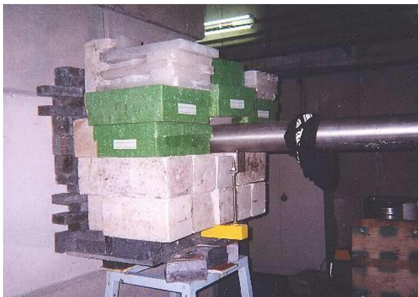
Rys. 3.2D.1 Osłona przed cząstkami naładowanymi i neutronami w Narodowym Laboratorium Ciężkich Jonów, GANIL, we Francji
