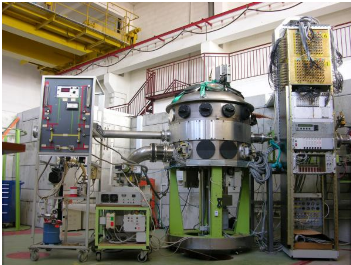
Rys. ŚLCJ-7.15: Komora ICARE do pomiarów cząstek naładowanych (fot. E. Piasecki)
