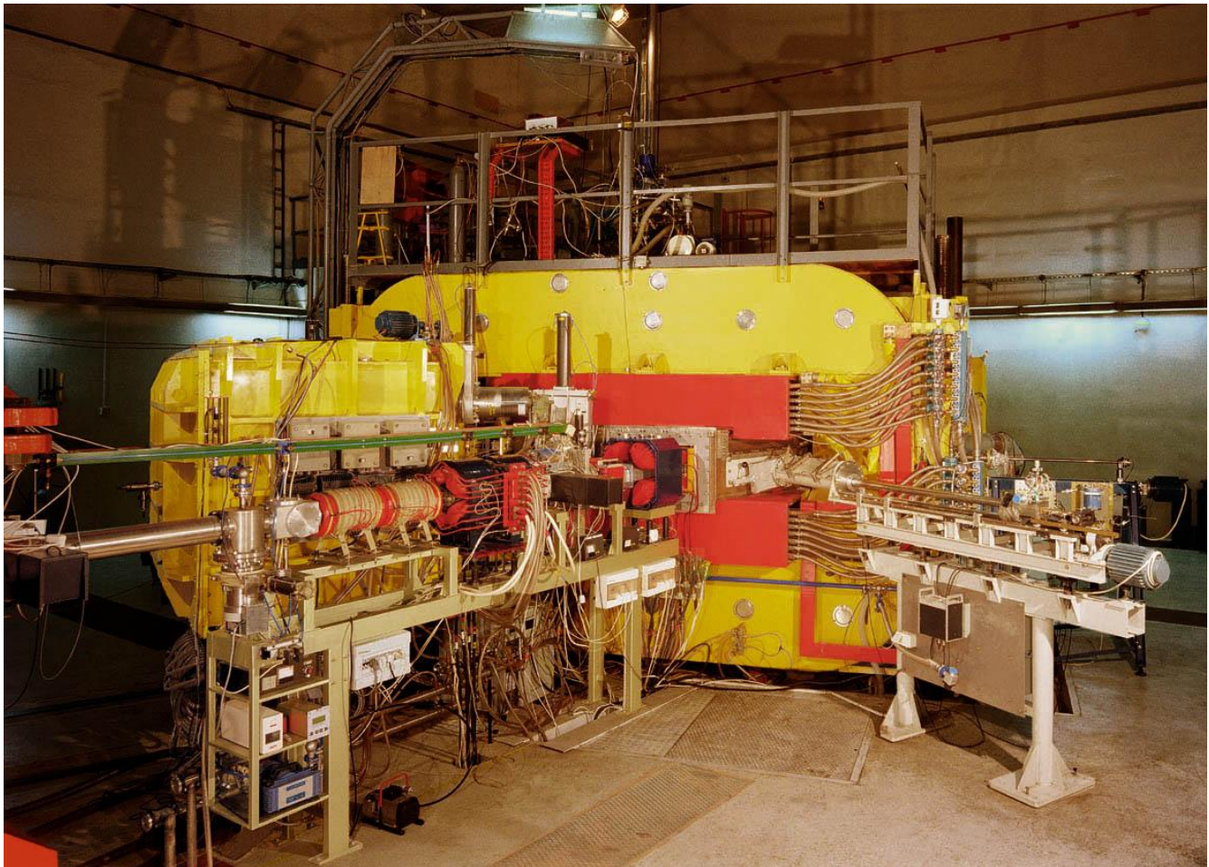
Rys. ŚLCJ-7.3: Cyklotron w ŚLCJ. Widoczny jest fragment jonowodu prowadzący jony do stanowisk eksperymentalnych (lewa strona zdjęcia) oraz układ służący do pozycjonowania folii strippera (z prawej strony) (fot. ŚLCJ)
