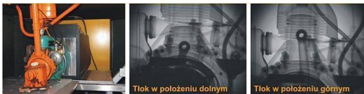
Rys. NCBJ-4.5. Wizualizacja struktury urządzenia technicznego za pomocą radiografii neutronowej (kanał H8)
