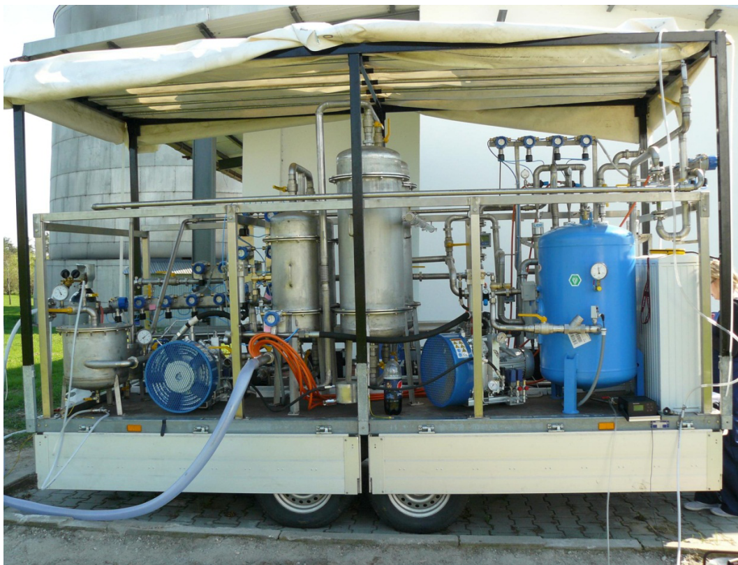
Rys. IChTJ 4.3 Mobilna instalacja membranowa do wzbogacania biogazu w metan (MIM)
