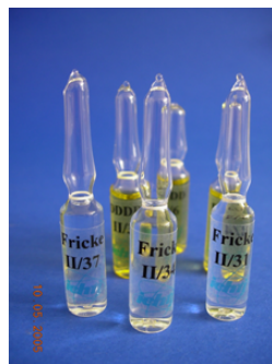
Rys. IChTJ 3.10.2 Dozometr Frickego: 20- 400Gy oraz dozometr dichromianowy: 2-50kGy
