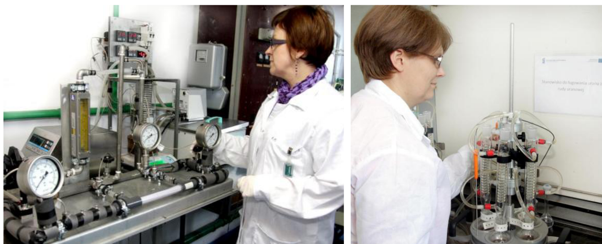
Rys. IChTJ 4.2 Stanowisko do destylacji membranowej oraz wielostanowiskowy zestaw do syntez i analiz służących do ługowania uranu z rudy uranowej
