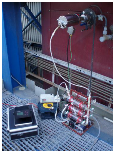
Rys. IChTJ 3.9.1 Pobór próbek gazowych z instalacji kotła fluidalnego. Na zdjęciu widoczny jest: miernik koncentracji gazów, grzana sonda i polowy zestaw do poboru próbek gazowych.
