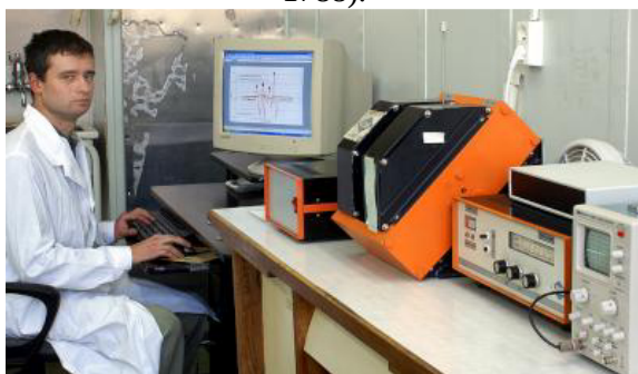
Rys. IChTJ 3.6.3 Pomiar na spektrometrze elektronowego rezonansu paramagnetycznego (ERP) przystosowanym do badań żywności zawierającej po napromieniowaniu trwałe rodniki (PN - EN 1786, PN - EN 1787, PN - EN 13708).
