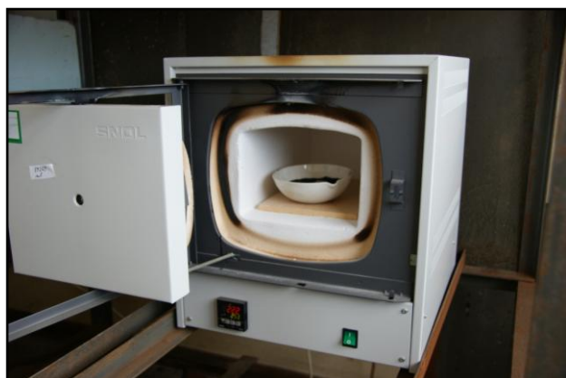
Rys. CLOR-15. Piec do palenia próbek żywnościowych przed obróbką radiochemiczną.
