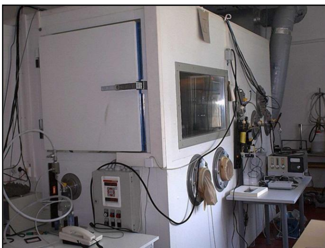
Rys. CLOR-3. Radonowe Stanowisko Wzorcowe – Komora radonowa. (fot. prof. J. Pluta)
