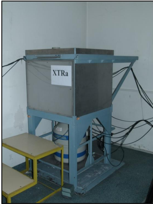
Rys. CLOR-8. Germanowy detektor półprzewodnikowy HPGe umieszczony w ołowianym domku osłonnym
