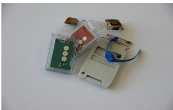
Rys. CLOR-24. Trzy rodzaje dozymetrów używanych w CLOR [CLOR-4].
