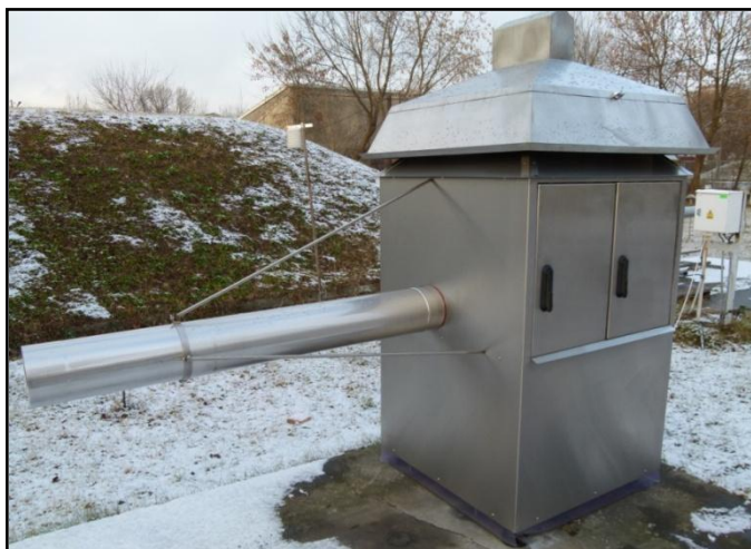
Rys. CLOR-11. Nowy model stacji NASS-500 pracujący w Centralnym Laboratorium Ochrony Radiologicznej w Warszawie.
