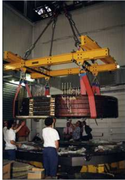
Rysunek 13. Sklejony i zaimpregnowany fragment LCT (wielkiej cewki) na podnośniku.
