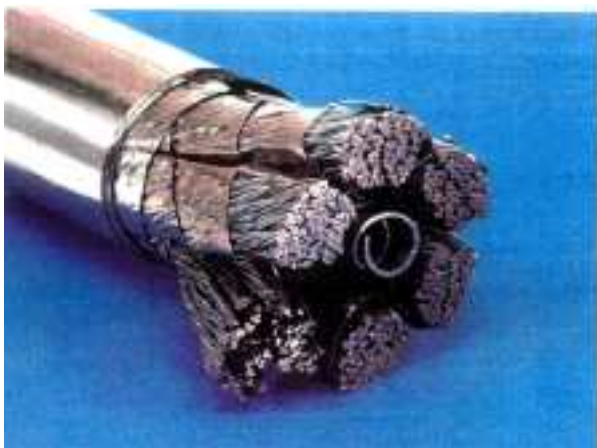
Rysunek 10. Przekrój wiązki kabla Nb3Sn
