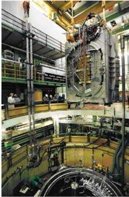
Rysunek 12. Wążący 117 ton układ zawierający TFMC (model cewki pola toroidalnego) zamontowany wewnątrz LCT (wielkiej cewki) wędruje do komory TOSCA
