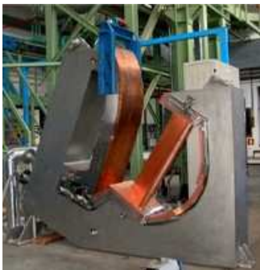
Rysunek 18. Pełnowymiarowy, zintegrowany prototyp diwertora zmontowany w ENEA w Brasimone (Włochy)
