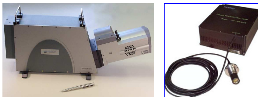
Rys. IFPiLM-13. Spektrometr Me5000 z kamerą iStar (iCCD) wykorzystywany do pomiarów metodą LIBS (po lewej) oraz laser światłowodowy Yb:glass (po prawej).
