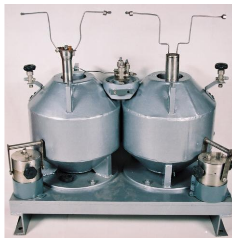
Rys. IChTJ 3.5.2 Generator źródła promieniowania (bromek metylu) aplikowanego do badanej instalacji przemysłowej
