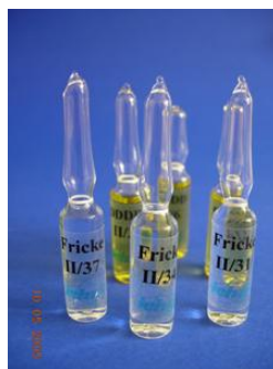
Rys. IChTJ 3.10.2 Dozymetr Frickego: 20- 400Gy oraz dozymetr dichromianowy: 2-50kGy
