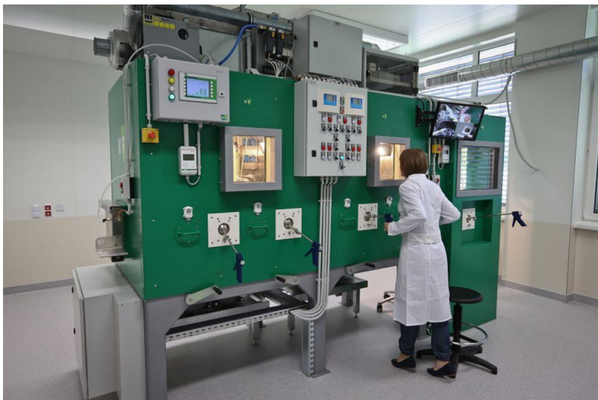
Rys. IChTJ 3.1.1 Komora gorąca do pracy z otwartymi źródłami promieniowania o dużej aktywności
