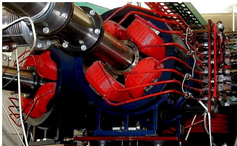
Rys. 2.2.28.a Magnesy kwadrupolowe w Środowiskowym Laboratorium Ciężkich Jonów UW
