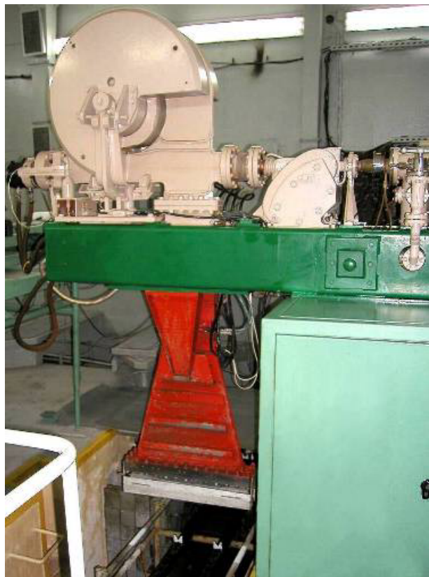
Rys. 2.2.1 Akcelerator elektronów w Instytucie Chemii i Techniki Jądrowej przeznaczony do sterylizacji materiałów medycznych
