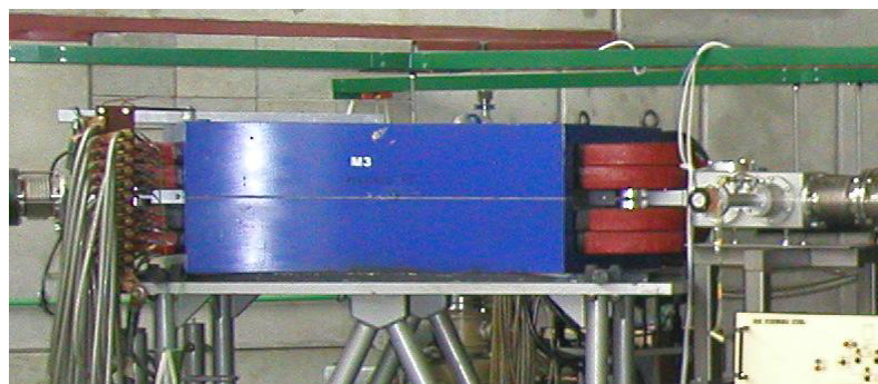
Rys. 2.2.28.b Magnes dipolow w Środowiskowym Laboratorium Ciężkich Jonów UW
