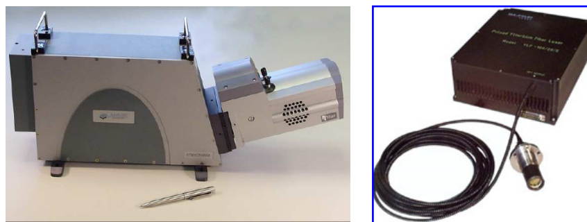
Rys. IFPiLM-11. Spektrometr Me5000 z kamerą iStar (iCCD) wykorzystywany do pomiarów metodą LIBS (po lewej) oraz laser światłowodowy Yb:glass (po prawej).
