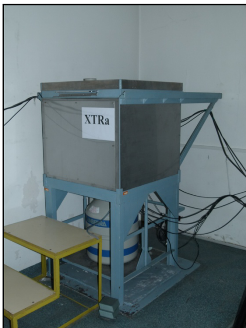
Rys. CLOR-8. Germanowy detektor półprzewodnikowy HPGe umieszczony w ołowianym domku osłonny
