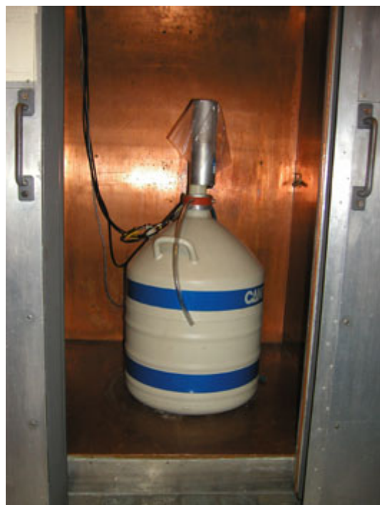
Na zdjęciu obok – detektor HPGe w pomiarowym domku osłonnym (CLOR)
