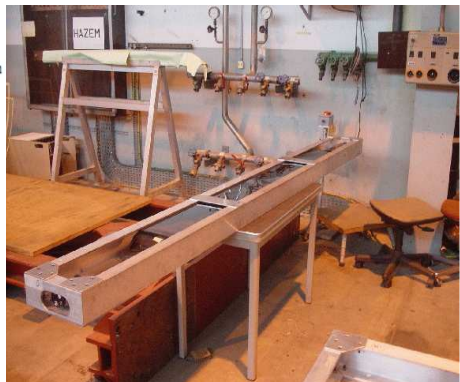
Rys. 2: Schemat oraz zdjęcie pojedynczego modułu detektora ACORDE
