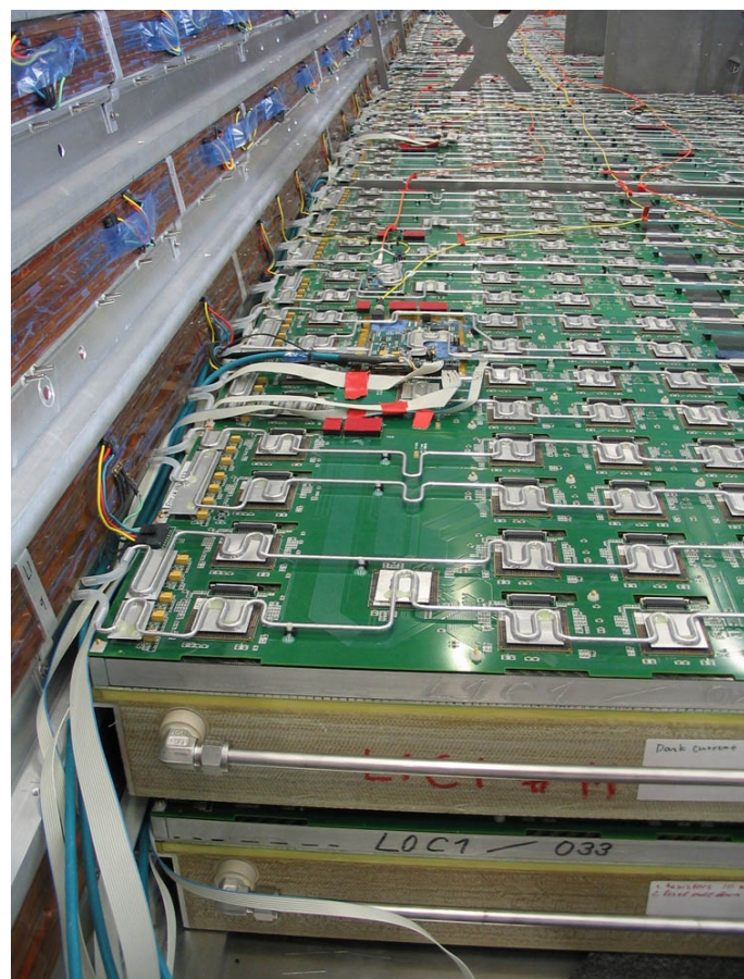
2 moduły w trakcie instalacji w supermodule
