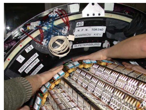
Instalacja SSD wewnątrz SSD
