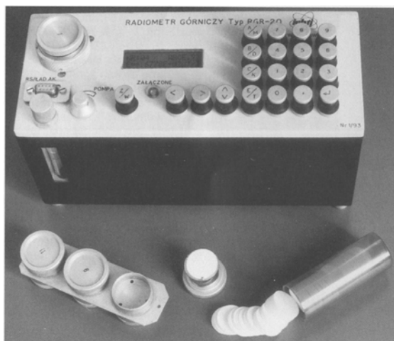
Rys. 5.5 Radiometr górniczy typ RGR-20 [3]
