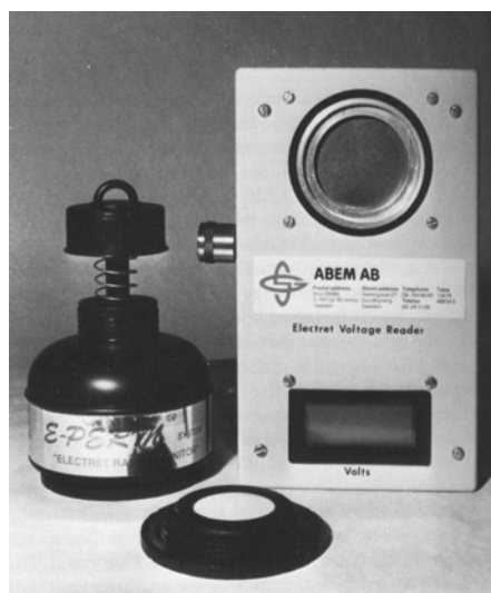
Rys. 5.3 Miernik typu E-Perm z elektretem [1]
