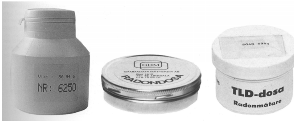
Rys. 5.2 Detektory zawierające węgiel aktywny oraz węgiel aktywny i TLD (po prawej) [1]
