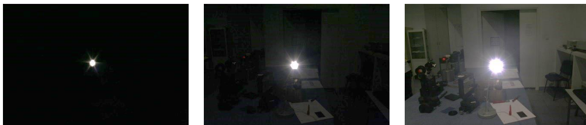
Rys. 14 – Różne metody pomiaru naświetlenia – jednopunktowy (z lewej), centralnie ważony (po środku) i wielopunktowy (po prawej).
