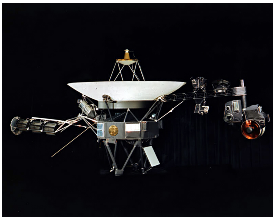
(a) Sonda Voyager. Sondy Voyager 1 i Voyager 2 są identyczne w budowie. Źródło:[20]
