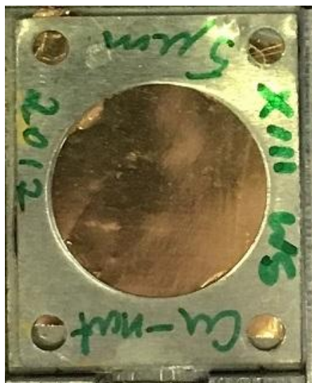
Rysunek4 .Przycięta i przyklejona do ramki tarcza
