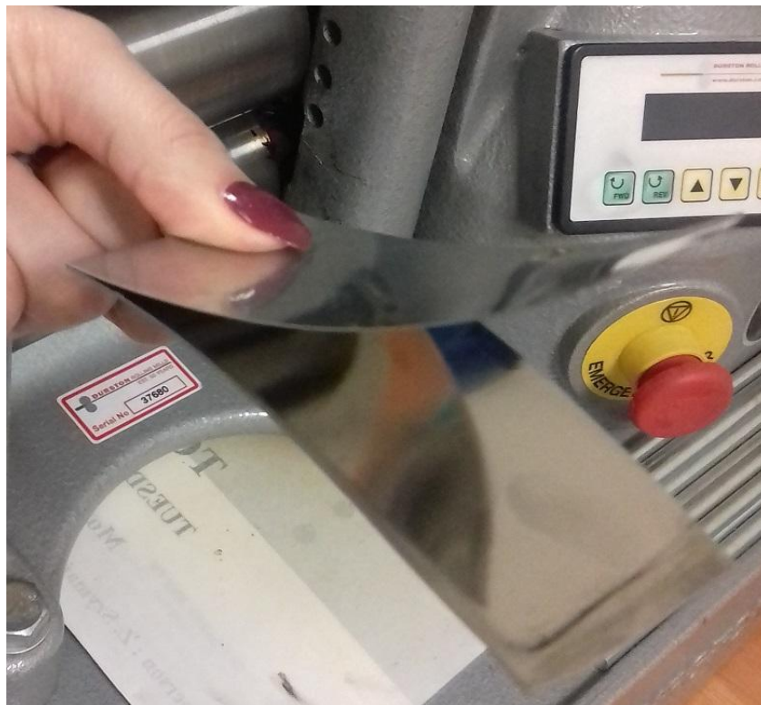
Rysunek2 ."Kanapka" w której walcowany jest materiał na tarczę
