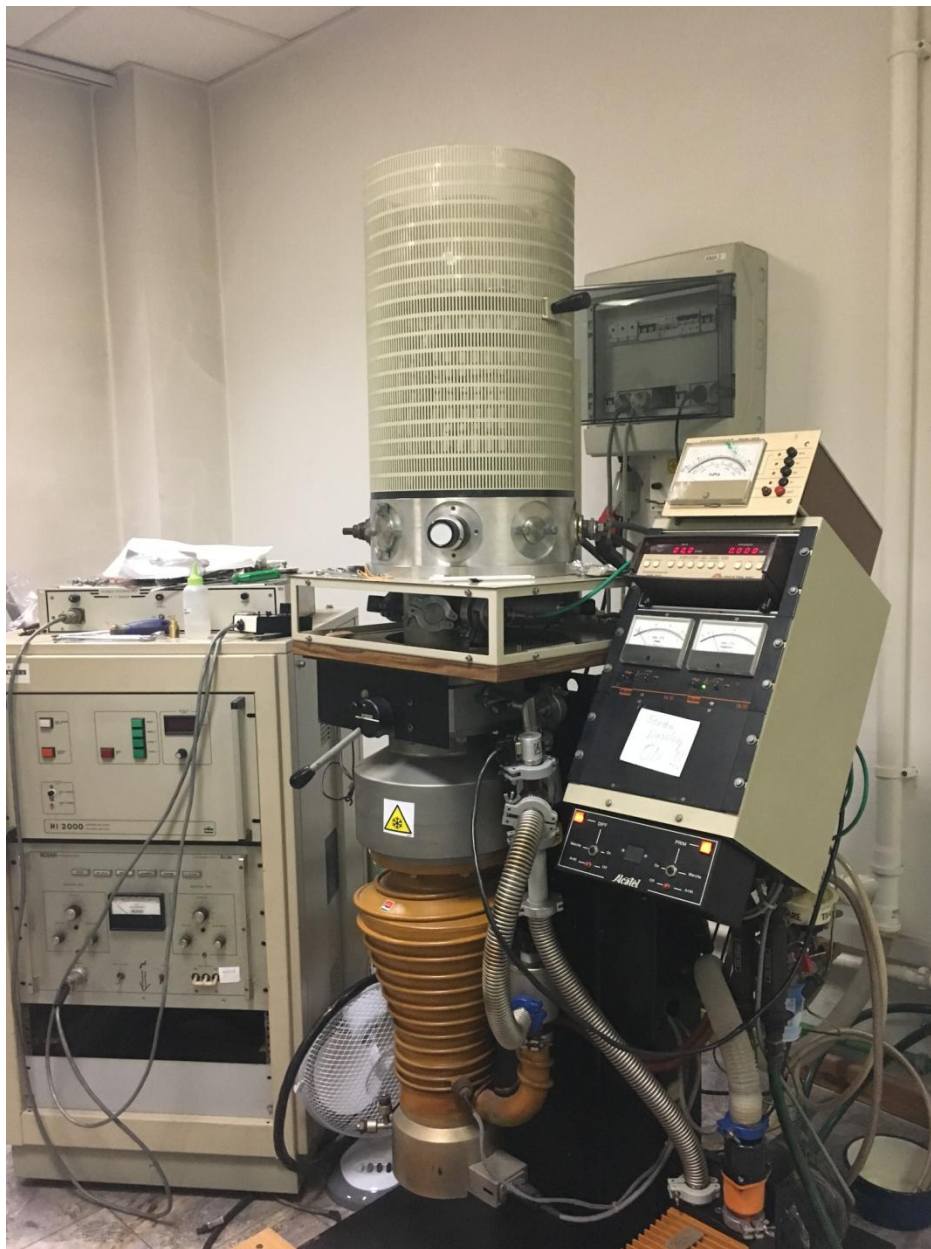
Rysunek6. Gotowy układ wraz z elementami zasilającymi, pompa próżniowa i aparatura pomiarową (mikrowagą kwarcową)
