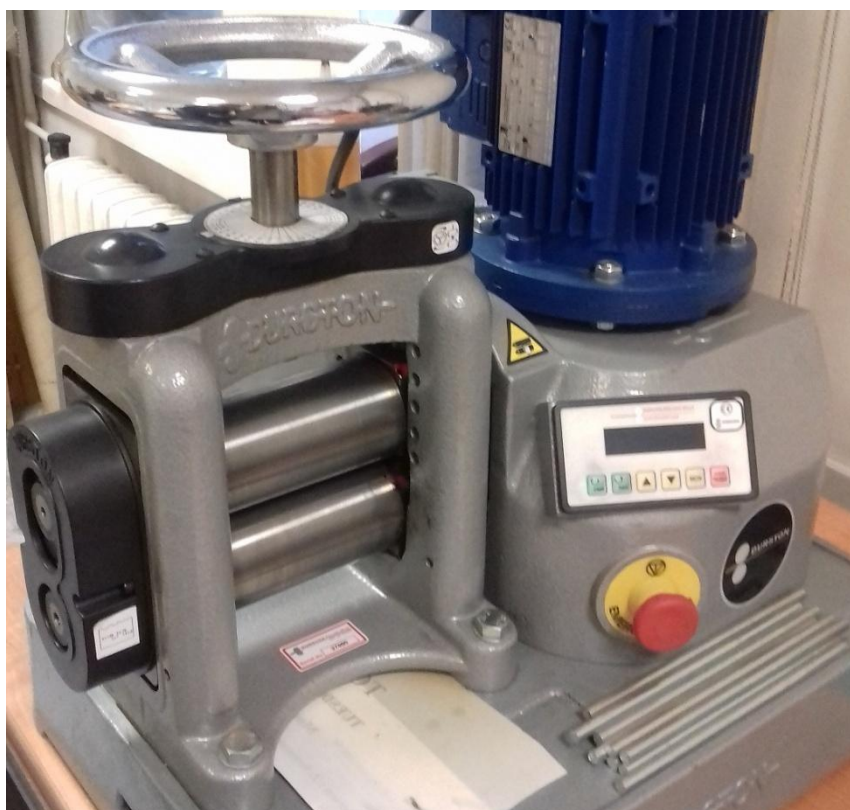
Rysunek3. Walcarka używana do produkcji tarcz
