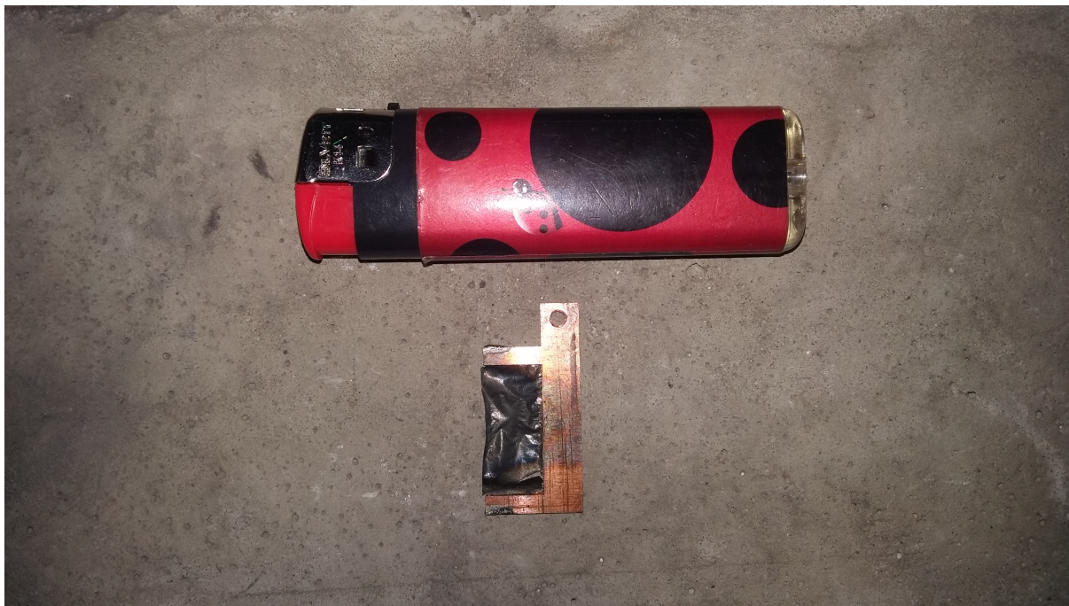
Rysunek 22: Zdjęcie wypalonego strippera dla porównania z zapalniczką.
