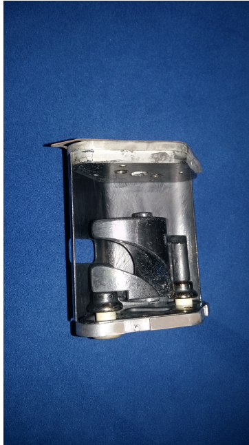
Rysunek 11: Zdjęcie przedstawiające zapasowy inflektor spiralny.
