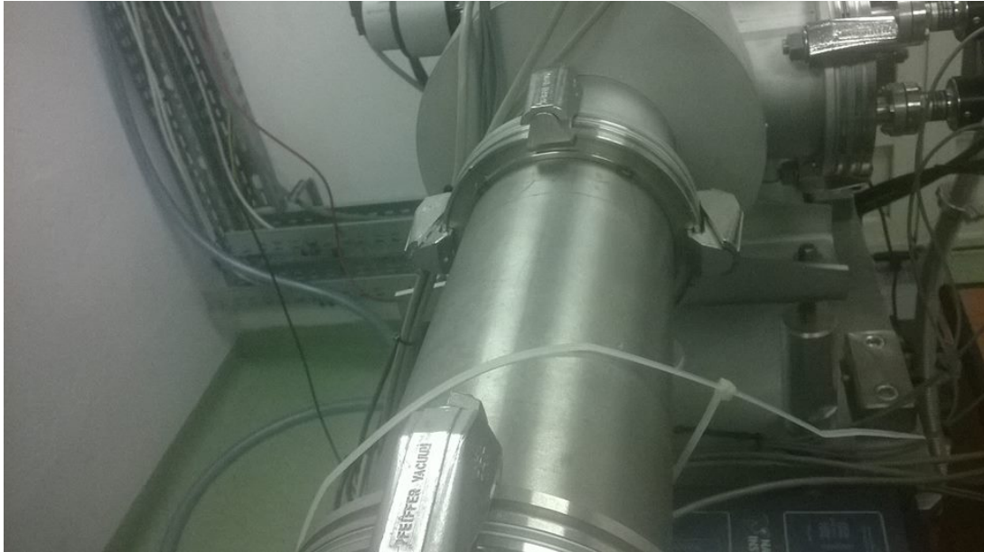
Rysunek 6: Zdjęcie fragmentu jonowodu J3 między kwadropolami Q2 oraz Q3.
