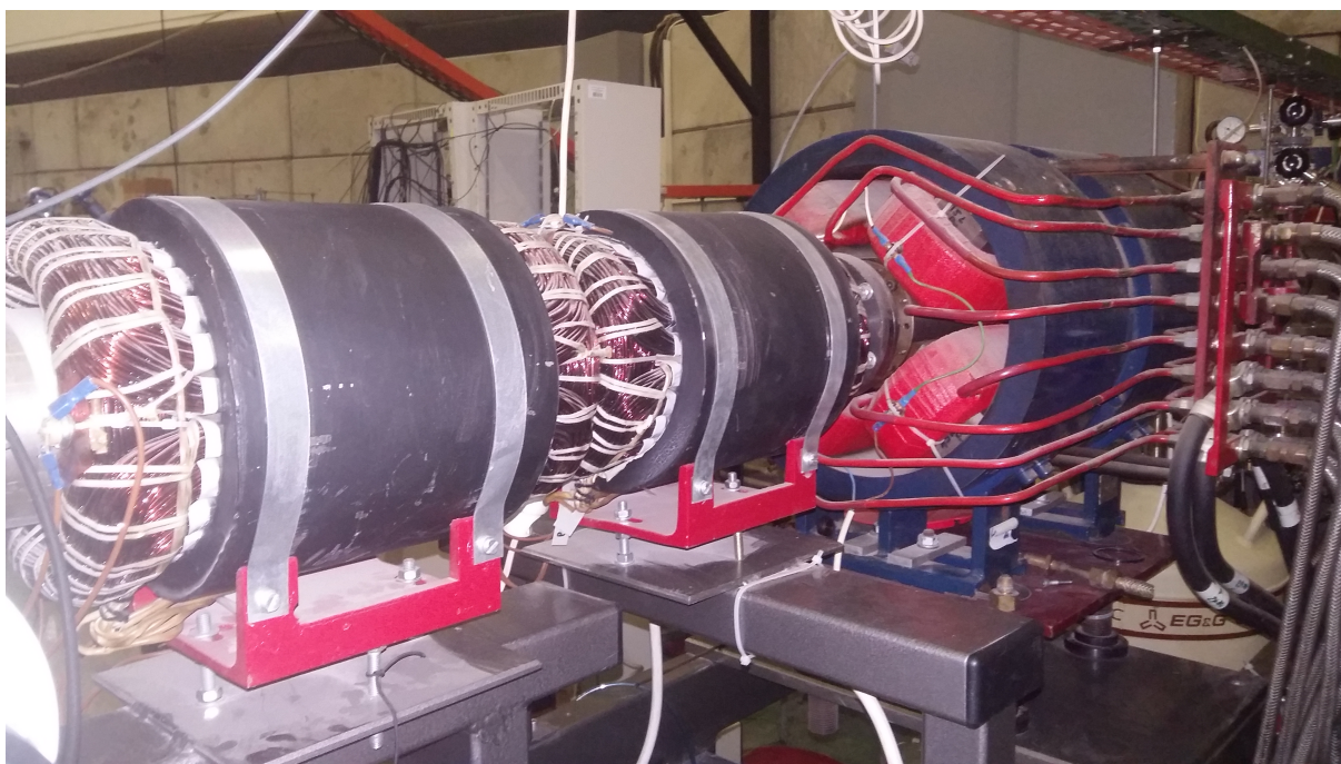
Rysunek 9: Zdjęcie zestawu kwadrupoli za cyklotronem.
