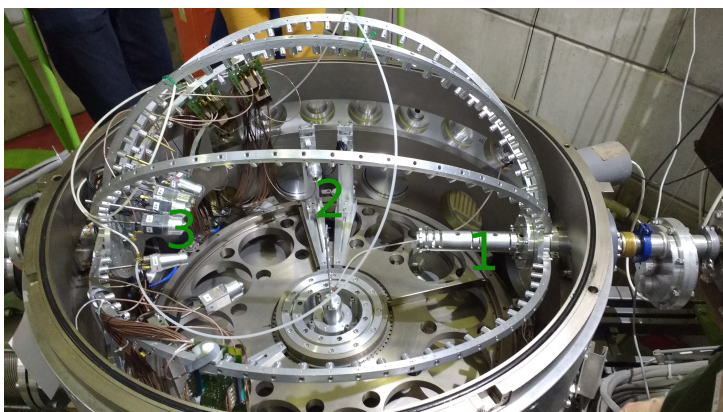
Rysunek 11: Komora spektrometru cząstek naładowanych ICARE, ŚLCJ UW, Warszawa. Widać tu poszczególne elementy układu używane w eksperymencie: jonowód (1), ramkę z tarczami (2), detektory (3).
