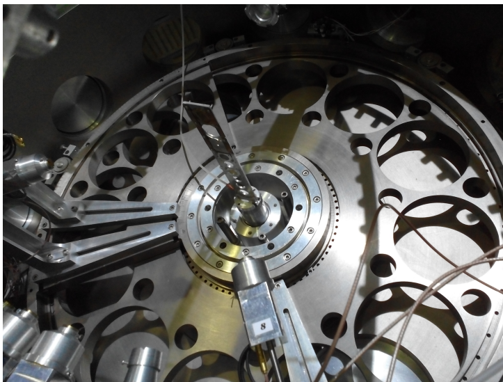
Rysunek 14: Ramka z tarczami: złotą ( ^{197}\text{Au} ) oraz węglową ( ^{12}\text{C} ), umieszczona w komorze rozproszeniowej układu ICARE.
