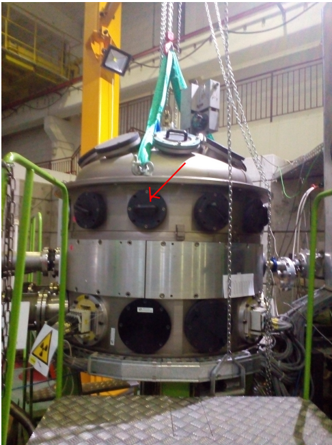
(a) Okienko komory rozproszeniowej układu pomiarowego ICARE.
