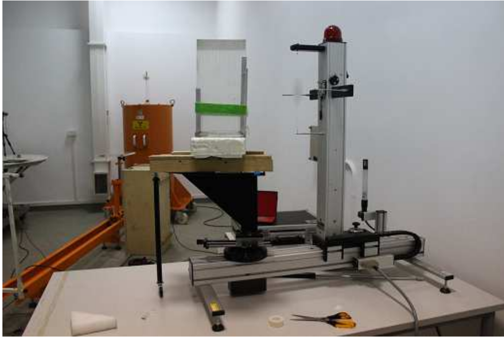
Rysunek 28 Stanowisko kalibracyjne beta. Na zdjęciu widoczny jest również fantom na który przymocowywane SA dozymetry podczas napromieniowań. Z tyłu znajduje się stanowisko neutronowe. Źródło; Własne.
