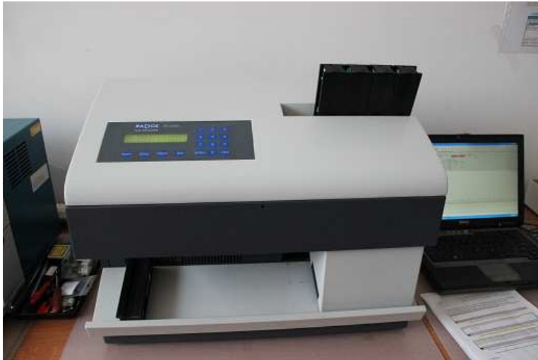
Rysunek 11 Czytnik pozwalający na odczytywanie widm z dawkomierzy termoluminescencyjnych. Źródło: Własne
