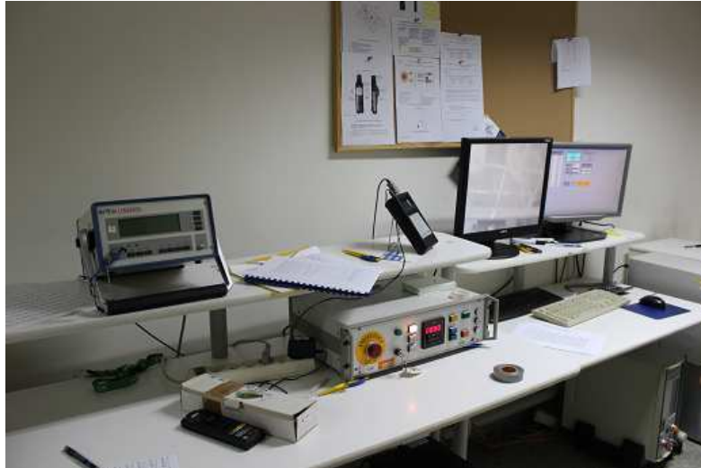
Rysunek 25 Sterownia stanowiska gamma. Po prawej stronie znajdują się monitory. Na jednym możliwy jest podgląd obrazu z kamery znajdującej się w pracowni, a na drugim ustawiana jest odległość ławy kalibracyjnej. Źródło: Własne.
