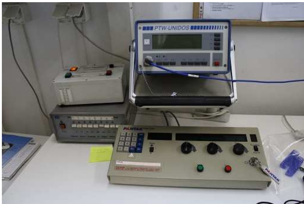
Rysunek 26 Sterownia stanowiska promieniowania rentgenowskiego. Widoczny jest UNIDOS a po lewej stronie znajduje się urządzenie sterujące karuzelą z warstwami pochłonnymi. Źródło; Własne.
