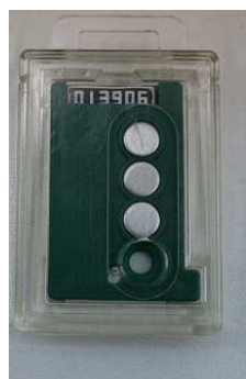
Rysunek 10 Dawkomierz termoluminescencyjny. Używany przez pracowników kategorii A. Źródło: Własne
