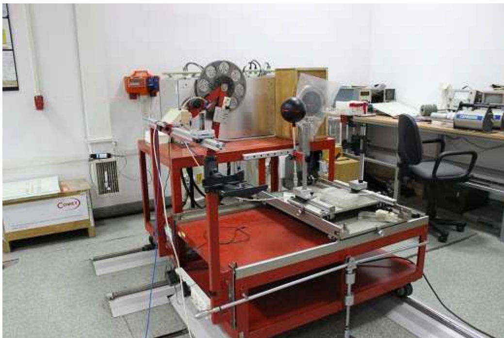
Rysunek 27 Stanowisko kalibracyjne promieniowania rentgenowskiego. Na zdjęciu widoczna jest ława kalibracyjna do której przymocowana została litrowa komora jonizacyjna. W dalszej części zdjęcia znajduje się koło z filtrami, które pozwalają na uzyskanie poszczególnych widm wymienionych w tabeli 1. Źródło: Własne.
