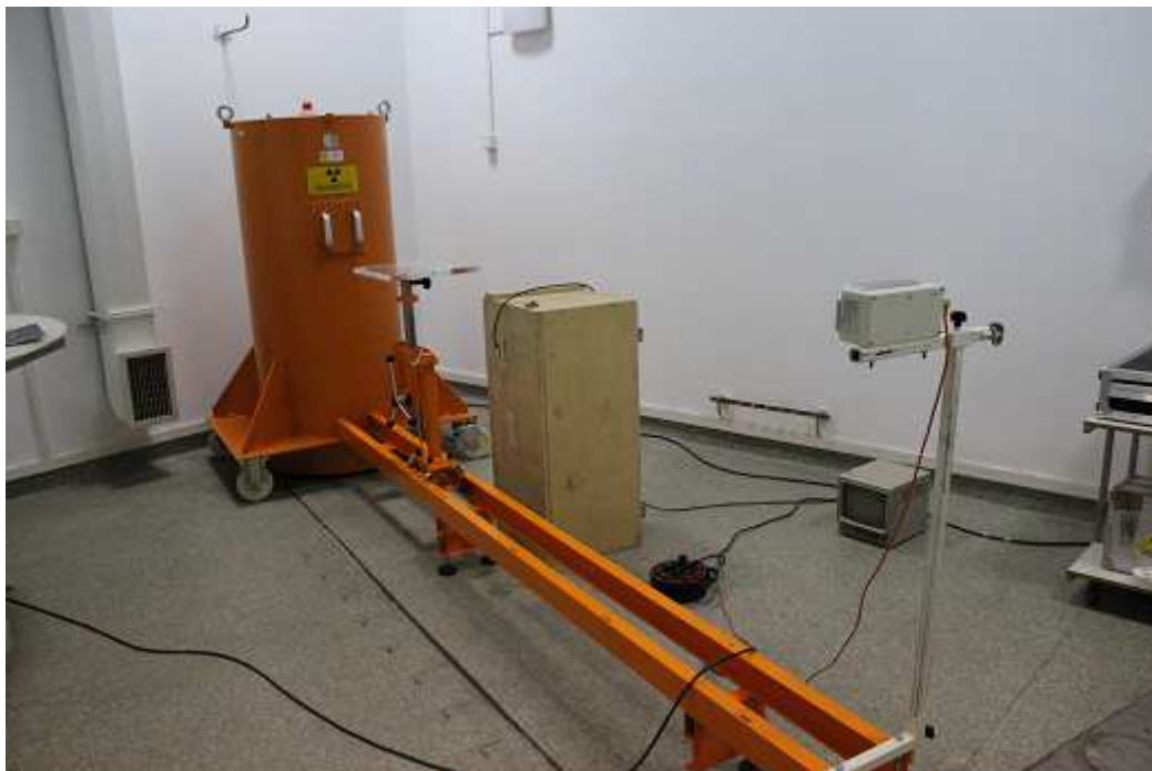
Rysunek 29 Stanowisko kalibracyjne neutronowe. Szyny pozwalają na regulowanie odległości. Źródło: Własne.
