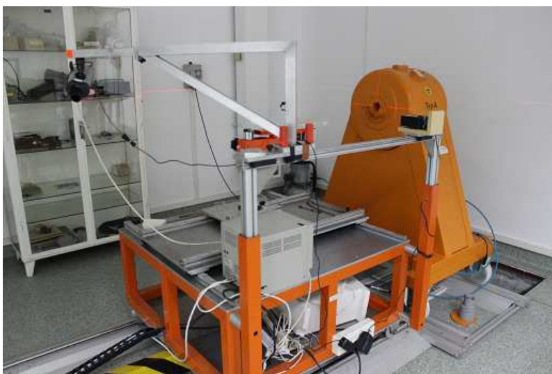
Rysunek 24 Irradiator wraz z ławą kalibracyjną. Widoczna jest również kamera dzięki której mamy możliwość podglądu przyrządów podczas napromieniania. Źródło: Własne.
