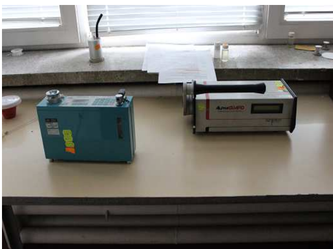
Rysunek 18 Przyrządy dozymetryczne. Po lewej stronie znajduje się radiometr górniczy, po prawej stronie znajduje się AlphaGUARD Źródło: Własne.
