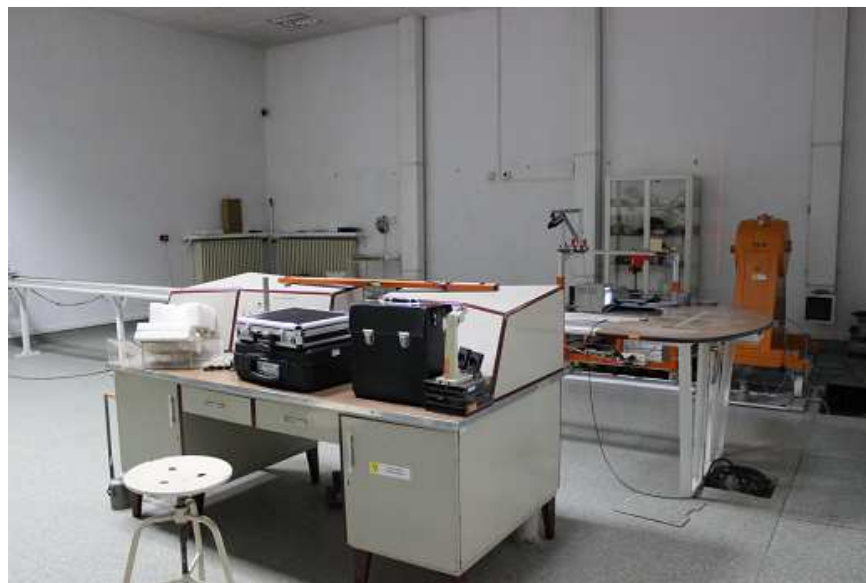
Rysunek 23 Stanowisko kalibracyjne gamma. Na pierwszym planie znajduje się biurko na którym pozostawione SA przyrządy dozymetryczne w dalszej części widać iradiator oraz lasery które pomagają w ustawianiu przyrządów w wiązce. Źródło: Własne.
