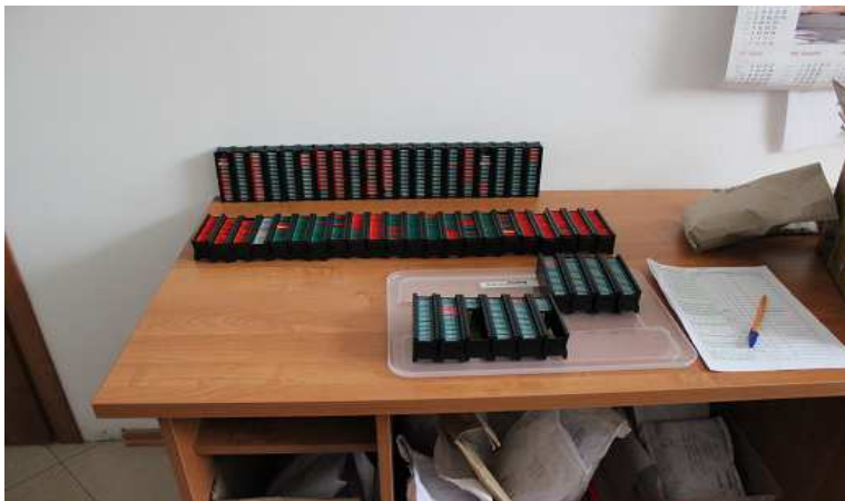
Rysunek 12 Kasetki z dozymetrami termoluminescencyjnymi które zostały już odczytane. Obok widoczne są koperty w których znajdują się dozymetry które należy jeszcze odczytać. Źródło: Własne.
