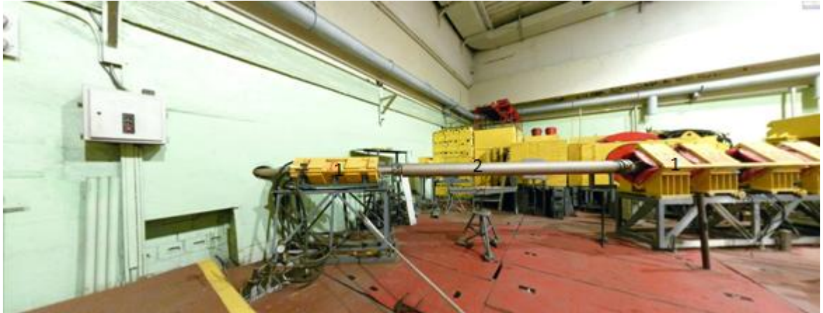
Rys. 23. Zdjęcie wykonane na hali, w której znajduje się fazotron [1. soczewki kwadrupolowe, 2. jonowód] [11]
