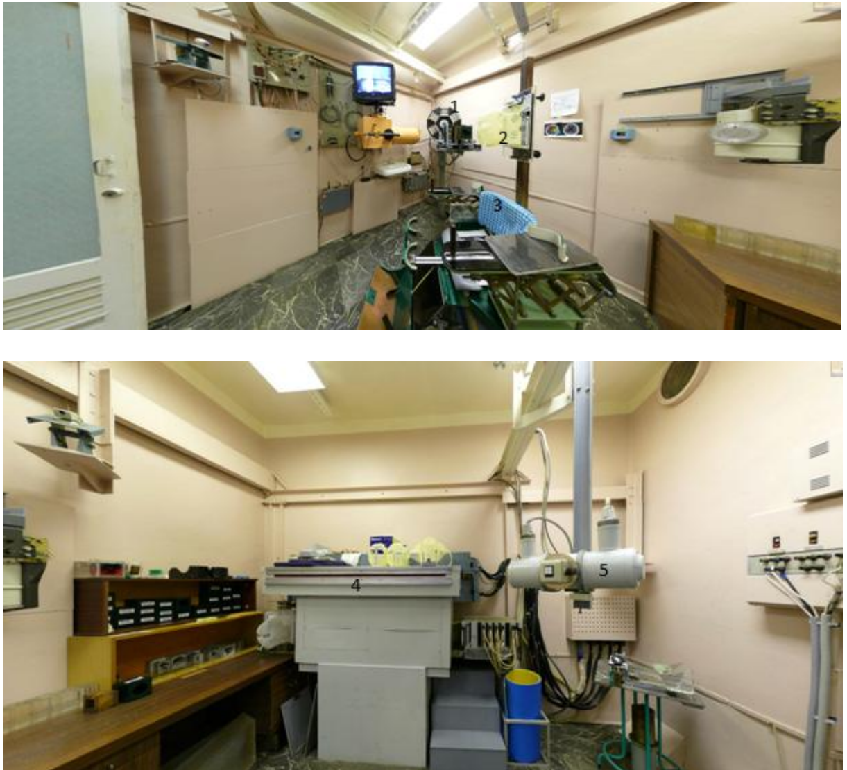
Rys. 25, 26. Zdjęcia wykonane w gabinecie zabiegowym, w którym odbywa się napromienianie pacjenta wiązką protonów [1. zestaw filtrów grzebieniowych; 2. maska mocująca wykonana z termoplastiku; 3. krzesło terapeutyczne; 4. zespół detektorów do rentgenowskiej tomografii komputerowej; 5. generator promieniowania rentgenowskiego]. [11]
