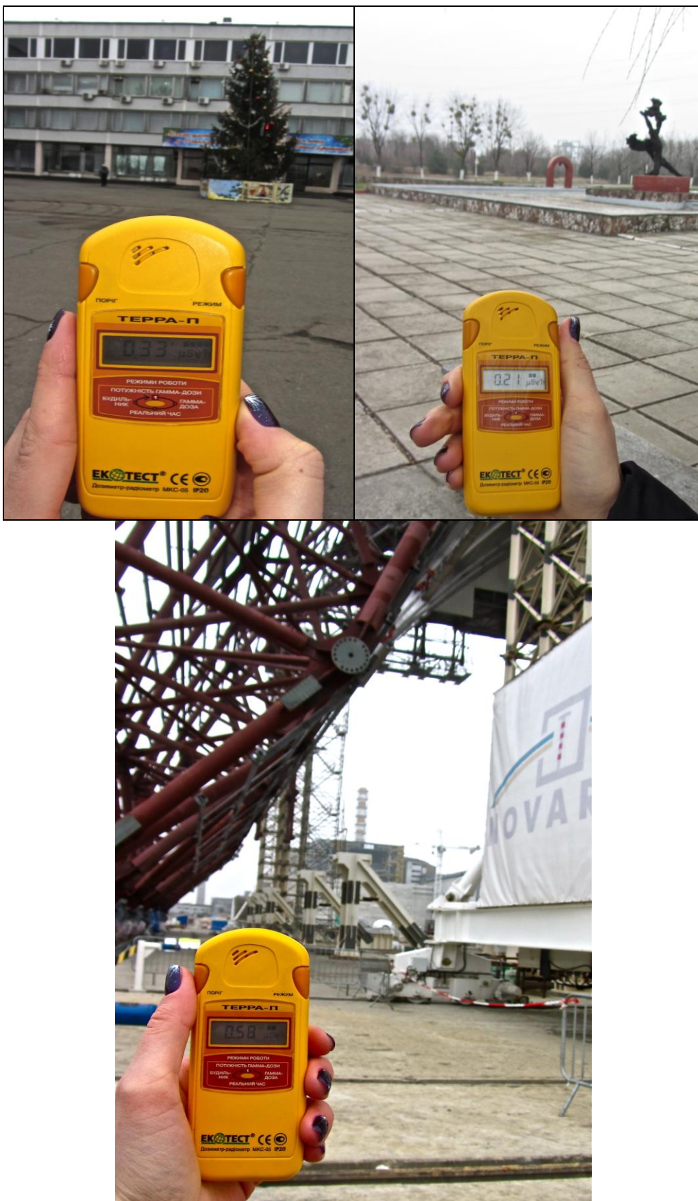
Rys.16 Zmierzone wartości promieniowania w strefie wolnego dostępu na terenie elektrowni. Wartości, wyświetlane przez dozymetr: 1 – 0,33 \mu\text{Sv/h} , 2 – 0,21 \mu\text{Sv/h} , 3 – 0,58 \mu\text{Sv/h} (zdjęcia z 03.01.14 wykonane przez autorkę)
