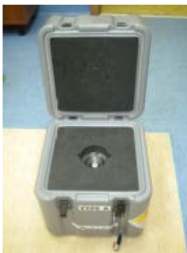
Rys. 6.1. Fiolka z izotopem w osłonach, w których jest dostarczana do ośrodka [źr. własne]
