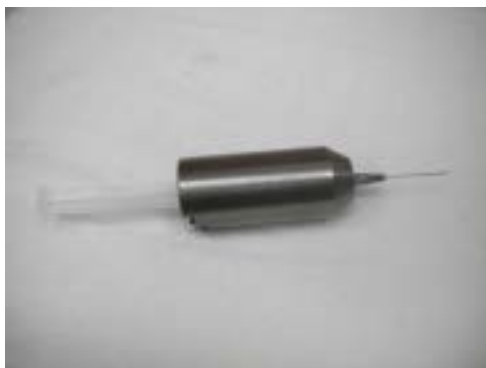
Rys. 6.4. Strzykawka w osłonie [źródło własne]
