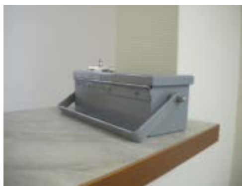
Rys. 4.8. Walizeczka stanowiąca dodatkową osłonę dla strzykawki z izotopem [źr. własne]
