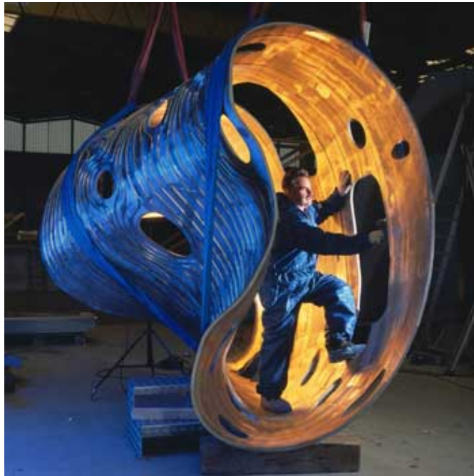
Rysunek 10: Jeden z 20 elementów komory plazmy stellaratora Wendelstein 7-X podczas produkcji.
