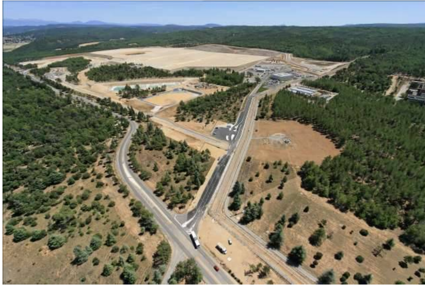
Rysunek 19: Budowa ITERa. Obecnie (III 2010) idealnie wyrównano teren o wymiarach 400 x 1000 m.[14]
