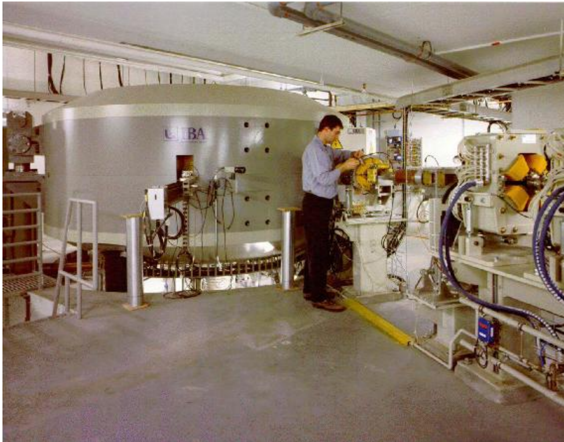
Rysunek 7: Cyklotron izochroniczny firmy IBA S.A. dedykowany do terapii protonowej o energii ekstrakcji 230 MeV, składający się z 4 segmentów i średnicy 4.3 m. Cała konstrukcja waży około 200 ton.
