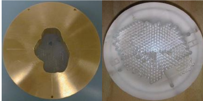
Rysunek 15: Kolimator i kompensator do terapii protonowej
