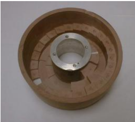
Rysunek 12: Przykładowy przesuwnik zasięgu z 3 torami odpowiadającymi za formowanie SOBP o różnych szerokościach.
