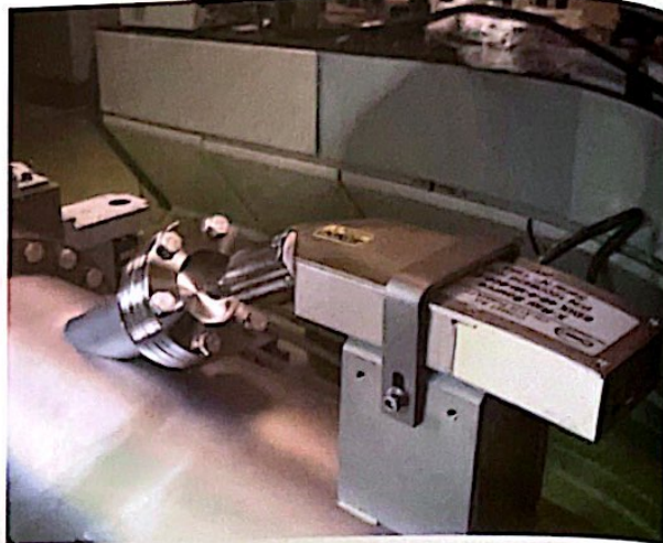
Układ pomiarowy do badania promieniowania rentgenowskiego emitowanego z plazmy w stellaratorze W7-X w Greifswaldzie (Niemcy). Układ przygotowany w IFPiLM do wspólnych badań w ramach projektu EUROfusion.
