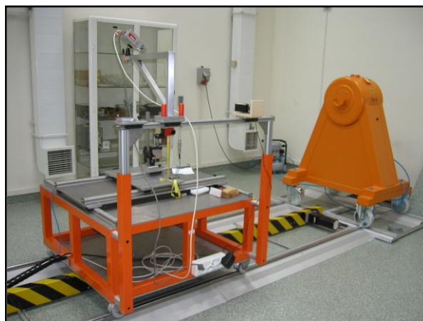
Rys. CLOR-2. Ława kalibracyjna w Laboratorium Wzorcowania Przyrządów Dozymetrycznych i Radonowych (fot. prof. J. Pluta)
