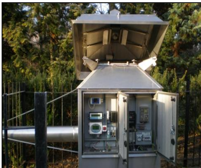
Rys. CLOR-5. Nowy model stacji ASS-500 (stacja NASS-500 – New Aerosol Sampling Station)
